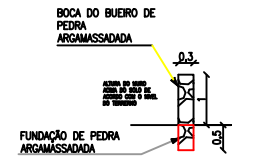
05 DETALHE DA BOCA DO BUEIRO ESCALA 1/150
